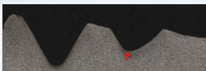
Werkstück mit verrundetem Gewindeeinlauf – kerbwirkungsfreie Gewindeenden Workpiece with rounded thread run-in area – thread ends without notch effect
