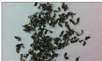
Copeaux en virgule standard. La forme et la longueur dépendent de la géométrie de la fraise et des paramètres de coupe.
