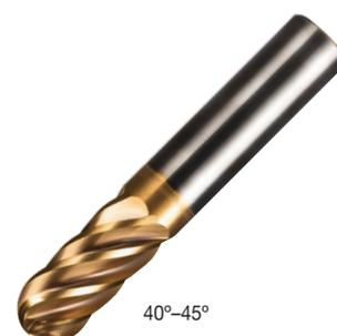
Pour des performances maximales, un angle d'inclinaison de 40°-45° entraîne un engagement complet de toutes les arêtes avec une large plage de profondeurs de coupe.
