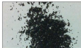
Les copeaux sont quasiment réduits en poussière. Il est conseillé de recourir au refroidissement à l'air comprimé pour évacuer les copeaux.
