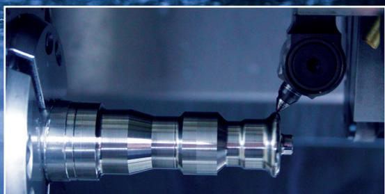
L'outil de galetage zeus est un outil polyvalent il s'adapte sur toutes les applications classiques - ainsi que les formes à galeter - cylindrique, s coniques, convexes ou concaves.
