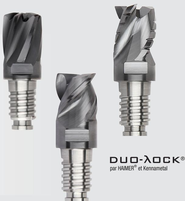
Duo-Lock™ est une nouvelle connexion révolutionnaire pour fraises carbure monobloc. Le concept de tête amovible associe grande concentricité et répétabilité longitudinale élevée avec un maximum de stabilité, formant une interface précise et quasi incassable.
