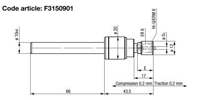
Softsynchro® Micro avec attachement cylindrique ø 10h6, version courte selon DIN 1835 A
