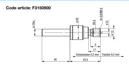
Softsynchro® Micro avec attachement cylindrique ø 10h6, version selon DIN 1835 B+E
