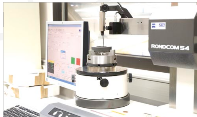
Mesure des tolérances de forme sur des bagues réglables Misura delle tolleranze di forma sui calibri di azzeramento ad anello
