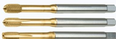
Ce taraud à refouler est approprié pour l'usinage d'aciers doux. Grâce à une géométrie particulière l'outil permet une déformation optimale du filetage. Le revêtement de nitrure de titane assure une protection optimale contre l'usure et un bon coefficient de friction.
