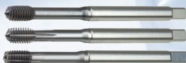
Cet outil est approprié pour l'usinage de matières avec une capacité de déformation limitée, p.ex. certaines fontes. Sa géométrie particulière, associée à un revêtement dur approprié, garantit une qualité élevée et une haute résistance à l'usure du taraudage refoulé.
