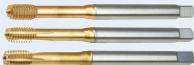
Version de base des tarauds à refouler InnoForm, appropriée pour l'utilisation universelle dans l'acier. Une géométrie optimisée et un revêtement de nitrure de titane garantissent un rendement élevé de ce taraud à refouler. Comparé avec les produits standard, le rendement de ce nouvel outil pour l'XC48 est jusqu'à 500% supérieur.
