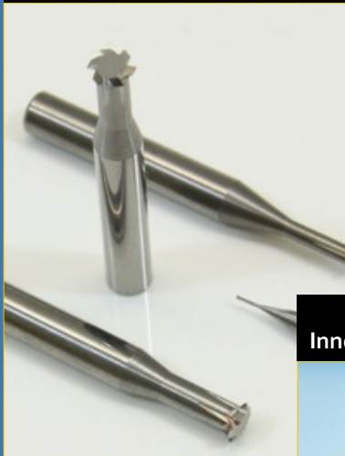
Innengewinde wirbeln/ Internal thread whirling
